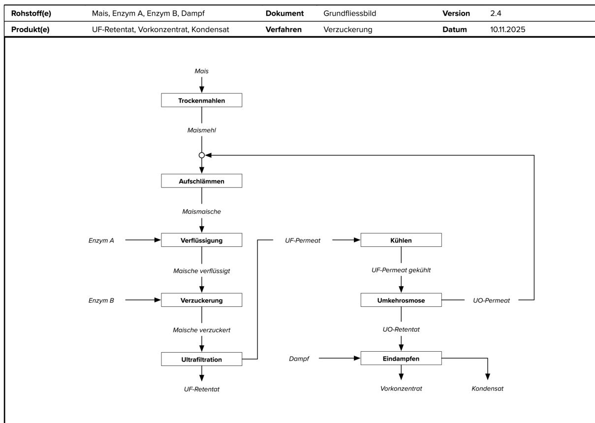
Das **Grundfliessbild** ist die Basis der Verfahrensentwicklung. Es zeigt das Verfahren in klaren Blöcken mit einfachen Linien, sehr direkt, sehr übersichtlich. Jeder Block steht für einen wichtigen Schritt, jede Verbindung für einen Materialstrom. Die Darstellung wirkt reduziert. Gerade dadurch liefert das Grundfliessbild sofort ein Gesamtbild des Ablaufs. Das Grundfliessbild setzt das Verfahren ins Bild.
